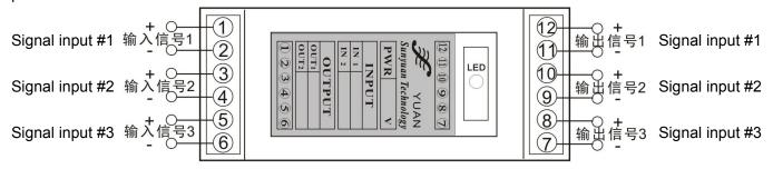
DIN 1X1/2X2/3X3(无源型) 多路I/V转换器
